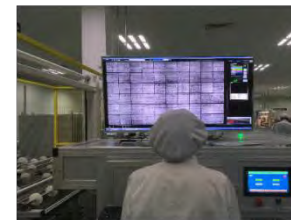
EL1检查 Electroluminescence Checking
